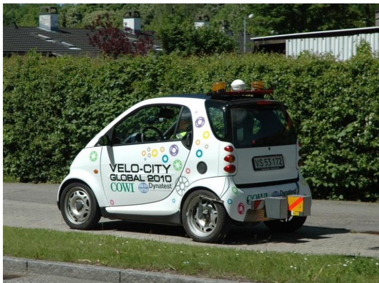
Figur 29: Specialbil til jævnhedsmålinger
